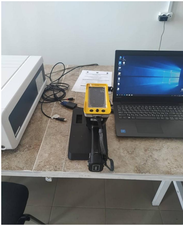
VantaC XRF VCW-CXX-G2 անալիզատոր
