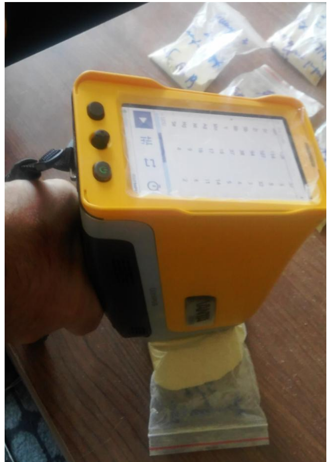
Նմուշի նախապատրաստման և քիմիական բաղադրության վերլուծության գործընթացը
